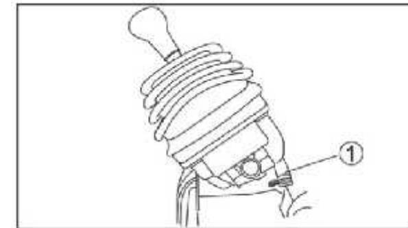
1. Трубка отстойник механизма
